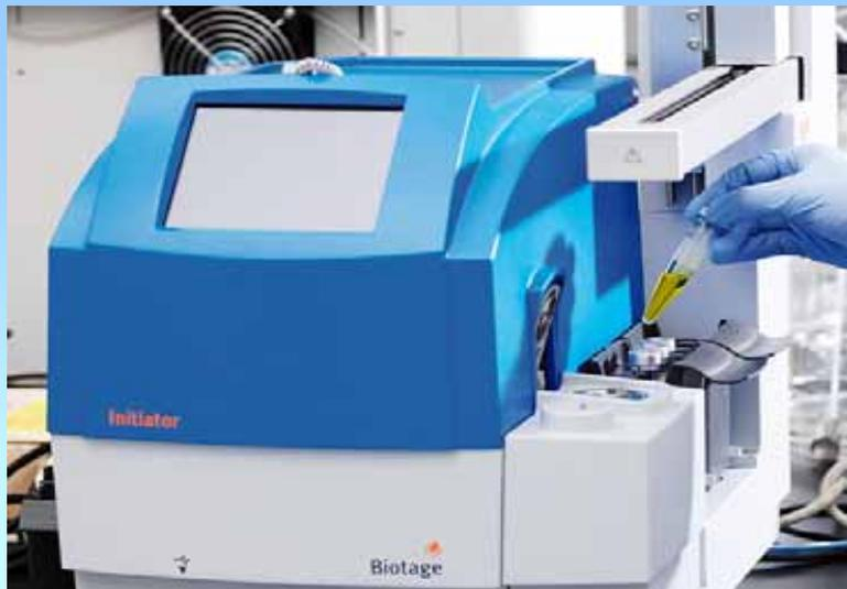
マイクロウェーブ合成装置による難化合物の合成
