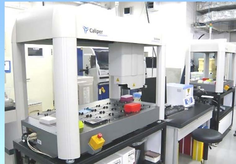
2台の分注ロボットにより276種類のキナーゼに対するプロファイリングを効率的に行う
